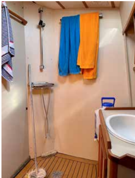
Bredvid pentryt om styrbord en toalett med duchutrymme, ny durkbeläggning med däckskork (2020)
